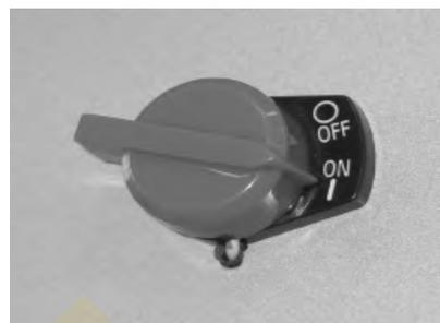
Рычаг топливного крана (1) повернуть вправо.
