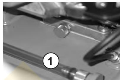
Прикрутить маслосливную трубу на спускной клапан (2) двигателя и слить масло.
