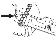
При замене режущего диска на новый, проверяйте фланцевые шайбы и ведущую ось. Выполняйте указания в разделе Проверка ведущей оси и фланцевых шайб.
