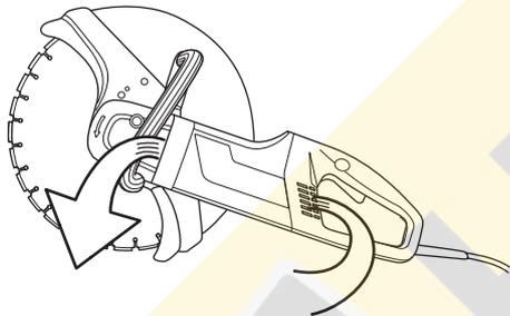
Чтобы машина всегда получала надлежащее охлаждение, сопла подачи холодного воздуха должны содержаться в чистоте и не должны быть ничем закрыты. Регулярно продувайте машину сжатым воздухом.
