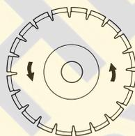
С задней стороны машины есть стрелка, показывающая направление вращения на оси крепления диска.
