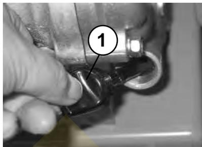
После полного опорожнения установить резьбовую пробку (1) на место. Заправить масло в соответствии со спецификацией.
